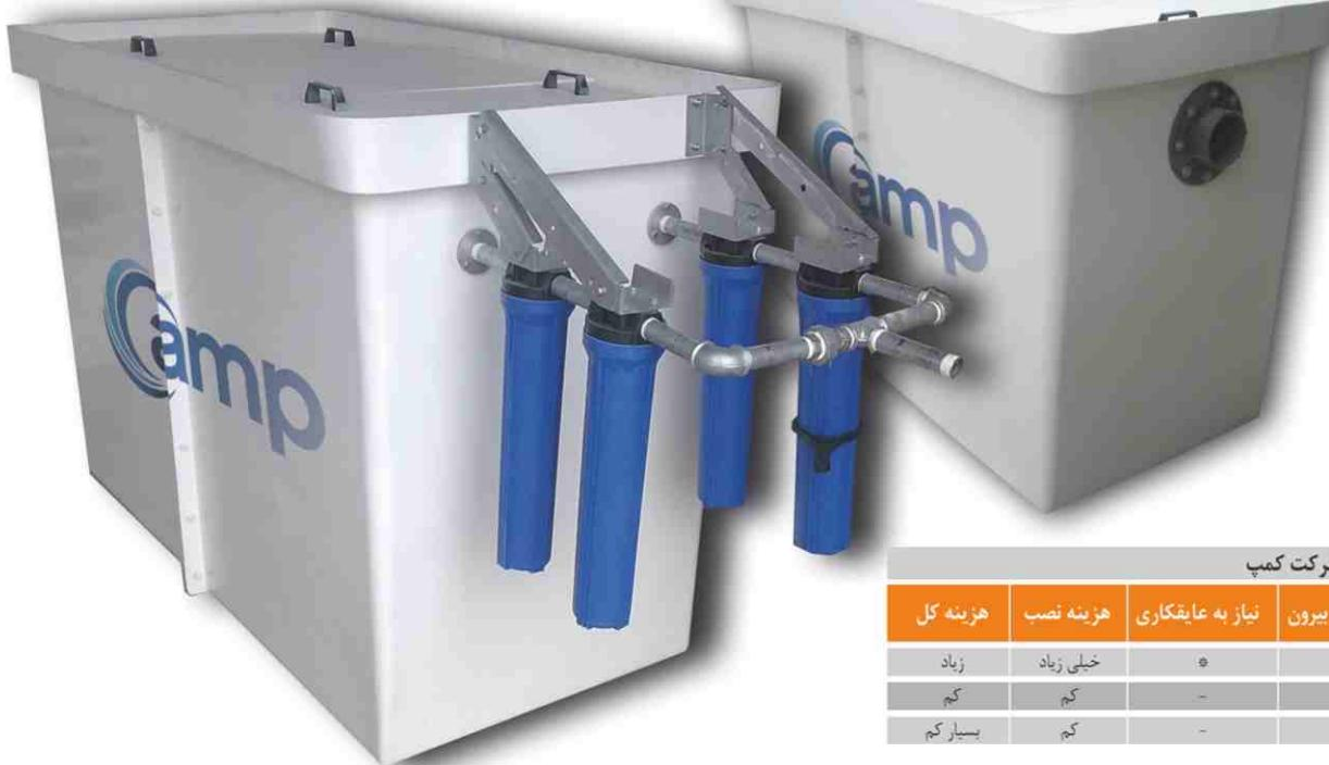
فاضلاب خروجی از ساختمان وارد چربی گیر شده و پس از رد شدن از آشغالگیر تمامی عوامل ریز و درشت از آن جدا شده و سپس توسط مکانیزمی وارد سیستم مدیا میشود که طی آن از سرعت پساب حاوی روغن کاسته شده و سرد میشود تا بصورت لایه ای ورقه ای روی سطح آب بصورت شناور باقی بماند. پساب بدون روغن از قسمت خروجی از سیستم خارج شده تا وارد فرآیندهای تصفیه فاضلاب گردد. چربی شناور روی آب و بین دو دیواره ی شناور بوده و از طریق خروجی مخصوص چربی و یا به صورت دستی از داخل چربی گیر خارج می شود.
